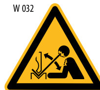
Warnung vor hochschnellendem Werkstück in einer Presse
