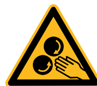
Warnung vor laufenden Walzen
